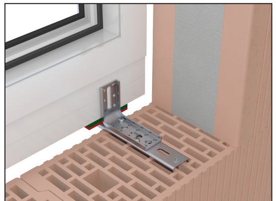
VBW-65x95x2,5 U-Profil, EL-Anker
